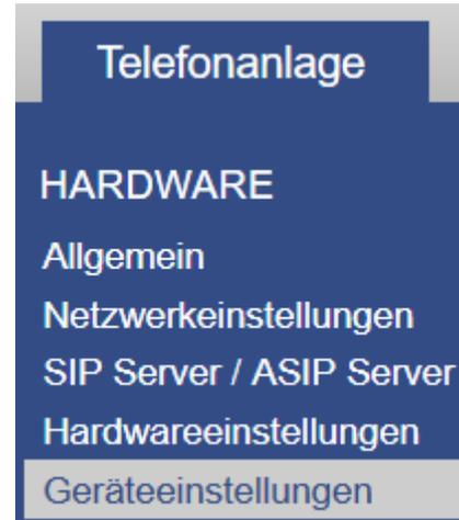
Dort ist der Anschluss-Port der angeschlossenen Türstation (TFE) aufzurufen und die *Betriebsart* auf *TFE* umzustellen. Im entsprechenden Konfigurationsfeld *Videostream-URL* ist der vollständige Pfad zum MJPEG-Videostream (per http) der Kamera zu hinterlegen.
