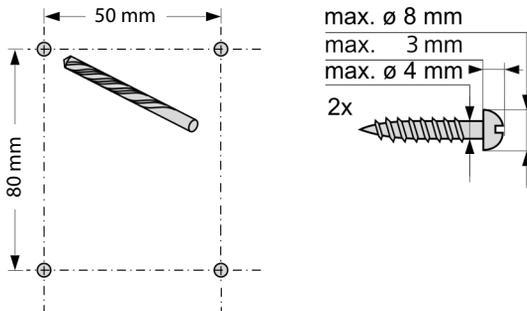
Sie können das Gerät mit zwei oder vier Schrauben an der Wand befestigen:
