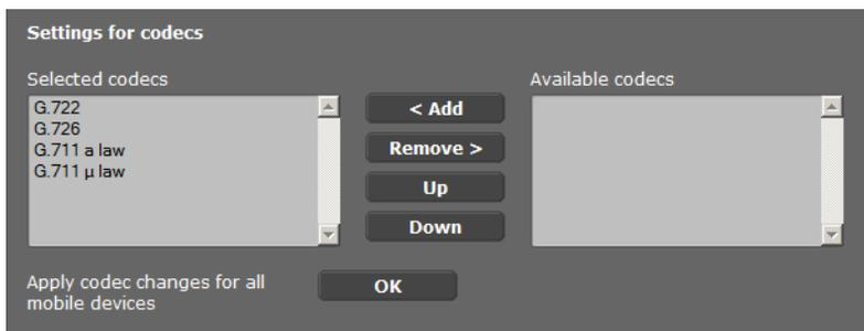
Beide Seiten einer Telefonverbindung (Anrufer-/Senderseite und Empfänger-Seite) müssen den gleichen Sprach-Codec verwenden. Der Sprach-Codec wird beim Verbindungsaufbau zwischen Sender und Empfänger ausgehandelt. Sie können die Sprach-Codex auswählen, die für dieses VoIP-Konto verwendet werden sollen, und die Reihenfolge festlegen, in der die Codex beim Aufbau einer VoIP-Verbindung vorgeschlagen werden sollen.
