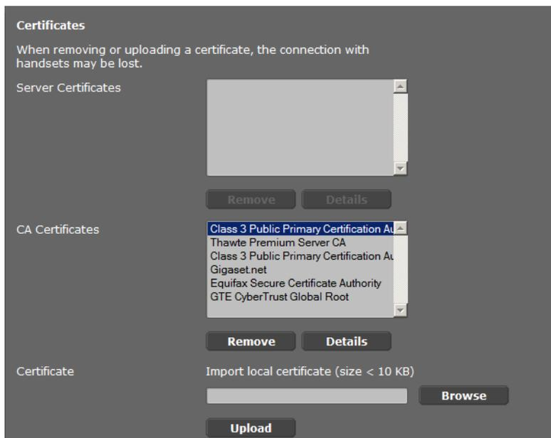
Auf dieser Seite finden Sie die Listen **Server-Zertifikate** und **CA-Zertifikate**. Es werden die im DECT-Manager gespeicherten Zertifikate angezeigt. Die Zertifikate waren entweder im Lieferzustand bereits gespeichert oder wurden von Ihnen mithilfe der Schaltfläche **Übertragen** auf den DECT-Manager geladen.
