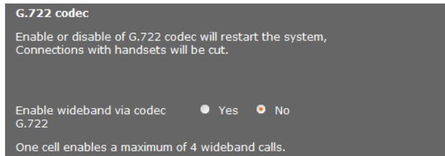
Der Codec G.722 (Breitbandverbindung) ermöglicht hohe Sprachqualität, aber nur maximal 4 gleichzeitige Verbindungen pro Basisstation.
