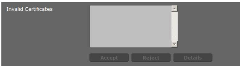
In der Liste **Ungültige Zertifikate** finden Sie Zertifikate, die den Zertifikate-Check bei einem Verbindungsaufbau nicht positiv durchlaufen haben, und Zertifikate aus den Listen **Server-Zertifikate / CA-Zertifikate**, die ungültig geworden sind (z. B. weil ihr Gültigkeitsdatum überschritten ist).
